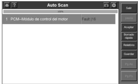
Figura 3.17: Pantalla del Menú del Sistema de Análisis Automático
