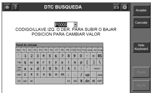
Figura 3.57: Pantalla OBD II-Búsqueda DTC
