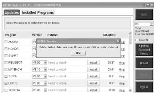
Figura 6.9: Pantalla de Fallo en la Actualización – Tarjeta SD Bloqueada
