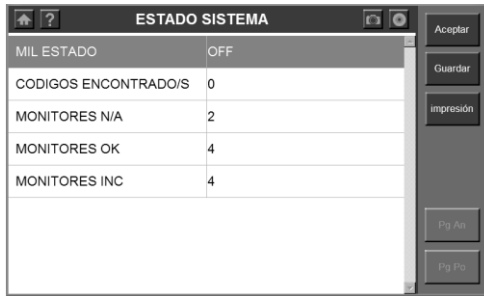
Figura 3.47: Pantalla OBD II - Estado del Sistema
